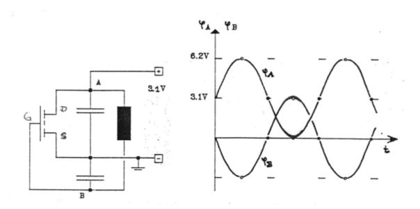
Wenn man die Betriebsspannung anschaltet ergibt sich das Bild oben. Wie der MOSFET den oberen Kondensator kurzschließt ist unstrittig denke ich ... siehe 705a?
