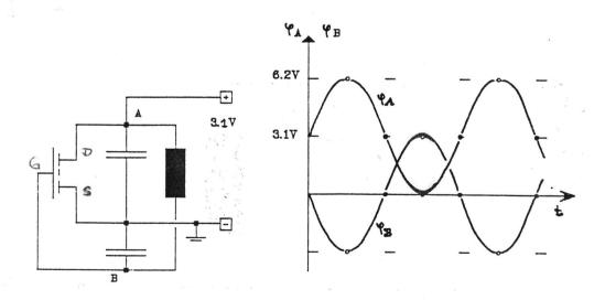
Man kann erkennen, daß die Gate-Source-Spannung immer dann über 3.0V steigt, wenn der obere Kondensator kurz vor seiner vollständigen Entladung steht. Genau in diesem Augenblick übersteigt die untere Kondensatorspannung 3.0V und damit erreicht die Gate-Source-Spannung den Schwellwert des MOSFET, er schaltet durch und schließt den oberen Kondensator kurz. Damit bleibt die volle Schwingungsamplitude erhalten.
