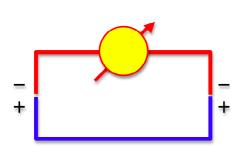
Verbindet man zwei Leiter aus verschiedenen Metallen (z.B. Kupferkabel und Konstantankabel) zu einem geschlossenen Stromkreis, dann wissen wir, dass an den beiden Kontaktstellen jeweils eine Kontaktspannung entsteht.
